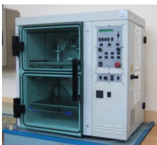
Equipement pour coulée sous vide (silicone + résine)
