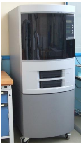
Imprimante 3 D : dépôt de fil plastique Résolution : 0,18
