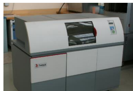
Imprimante 3 D : dépôt de cire Résolution : 0,04
